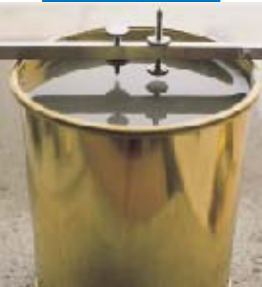
Vrije-uitzettingsproef in de plastische fase volgens UNI 8996/89
