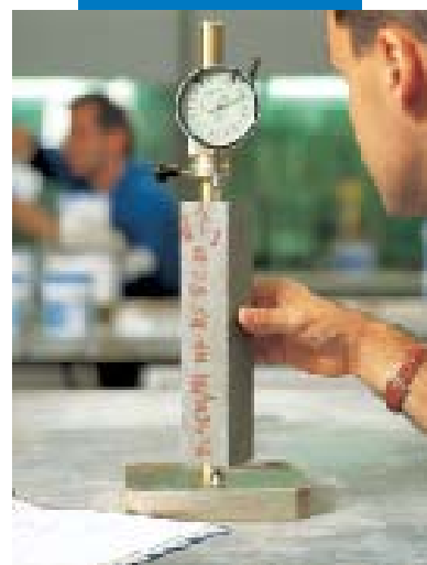
Bepaling van de gehinderde uitzetting volgens UNI 8147/80
